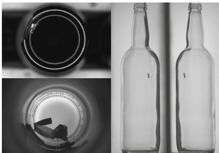
Detekované vady na hrdle a dně (vlevo) a stěně (vpravo)
