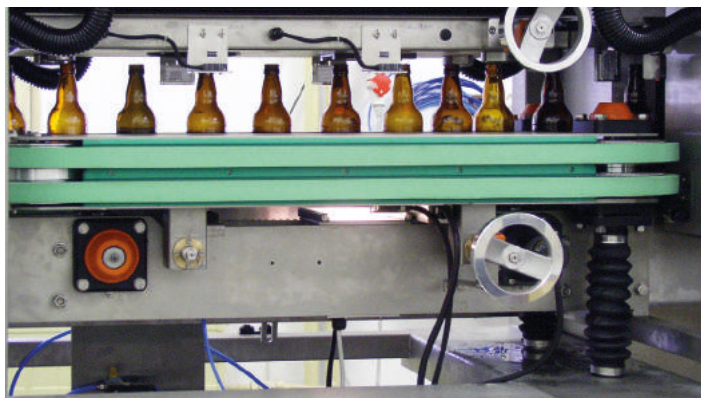
Vizuální systém UniscanBOTTLE v provozu
