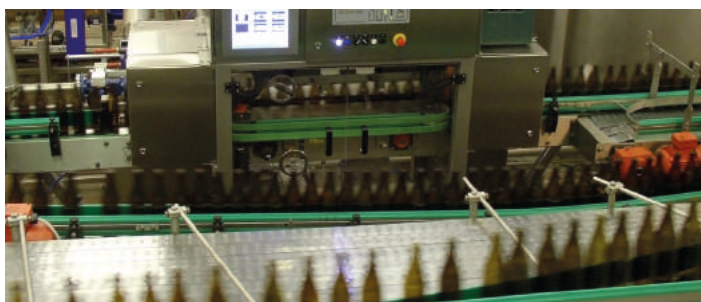
Plnicí linka osazená inspekčním systémem pro kontrolu lahví
